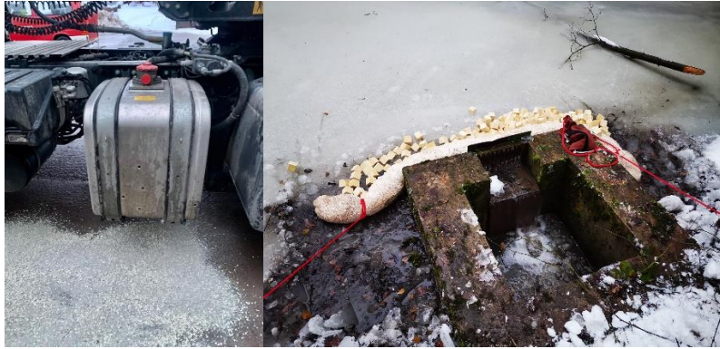
Gewässerverunreinigung durch aufgebohrten Dieseltank an einem LKW, Bekämpfung mit Ölsperren
